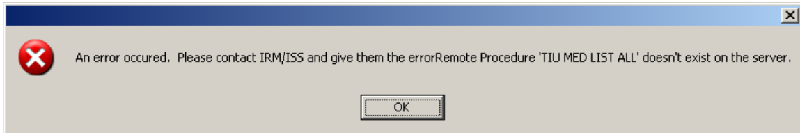
Figure 33. MED Error—Missing RPCs
